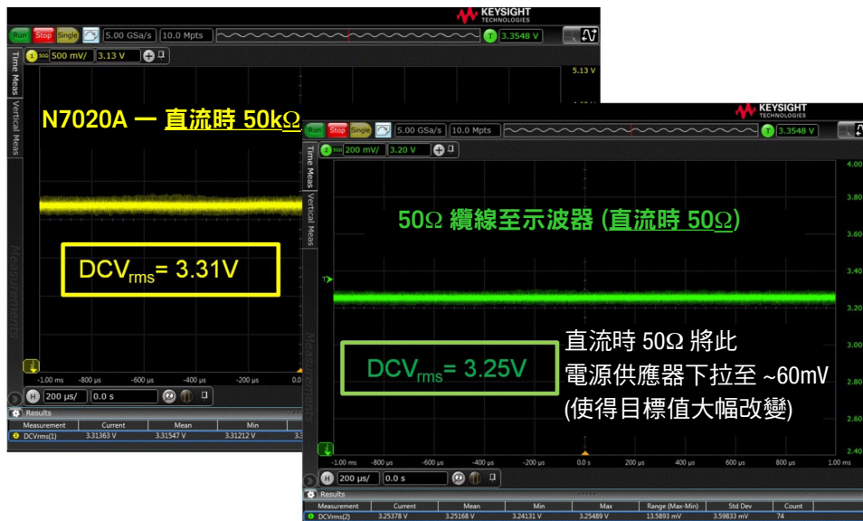
圖 7：探棒負載對電源的影響。使用 N7020A 電軌探棒以直流 50 kΩ 阻抗探測 3.3 V 電源，以及直接連接示波器 50 Ω 輸入進行相同電源探測。
