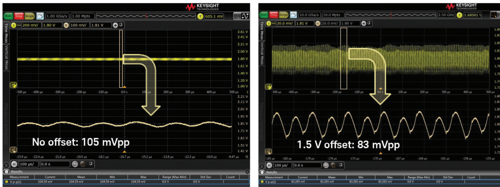
圖 4：在無偏移下量測 1.5 V 直流電源上的雜訊，並使用探棒偏移。
