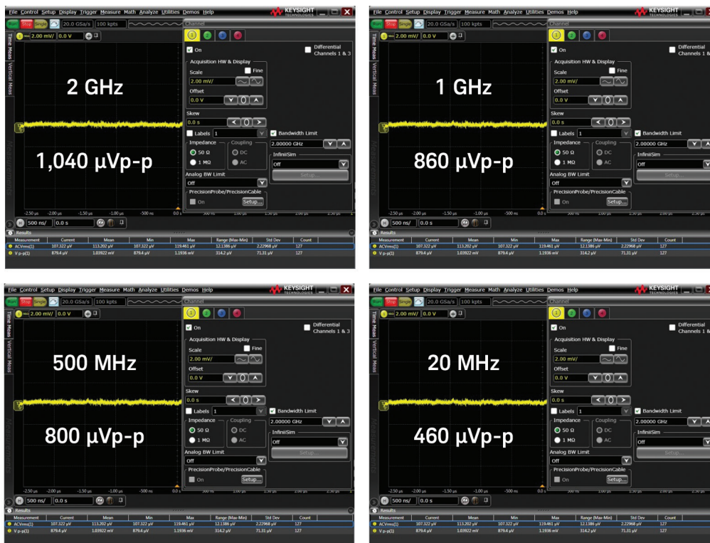
圖 2：N7020A 電軌探棒和 S 系列示波器在不同頻寬限制下的基線雜訊。
