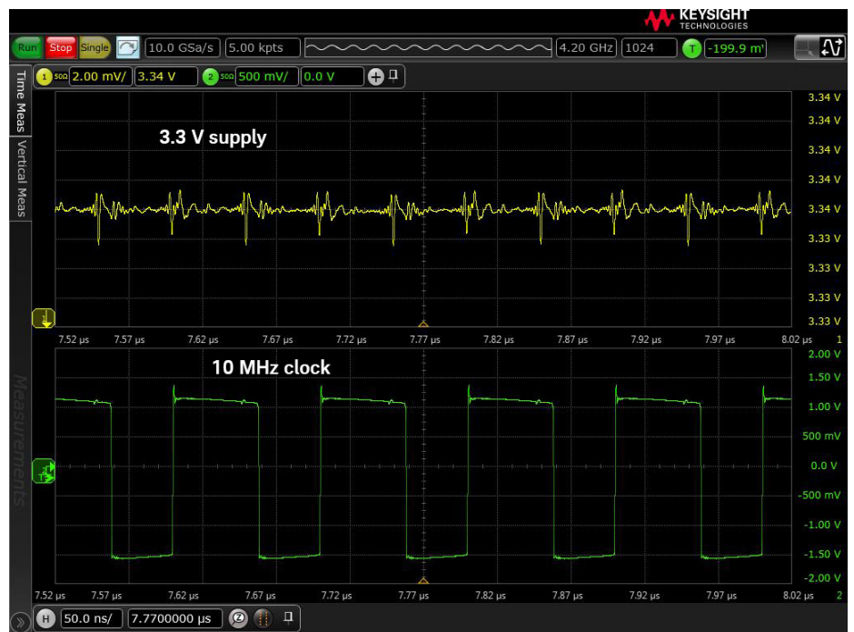
圖 11：在 10 MHz 時脈進行觸發並啟用平均功能，可移除所有與時脈不同調的隨機雜訊與信號。得到的視圖是與 10 MHz 時脈相關的電源雜訊。
