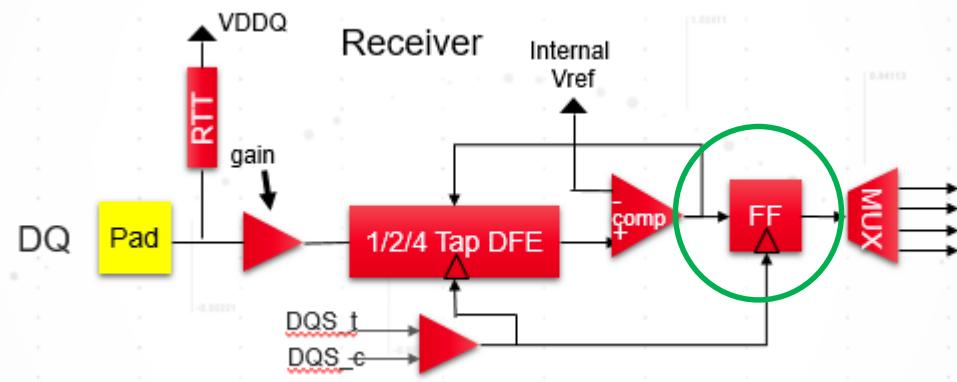
Internal delay alignment of DQS to DQ
